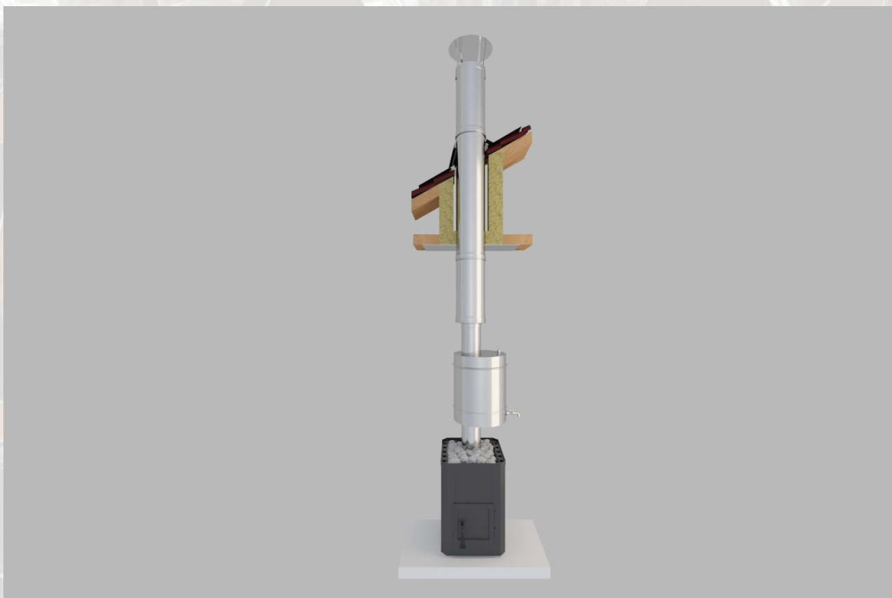
1. pav. Vandens talpos ir pirties dūmtraukio tipinis montavimo brėžinys
