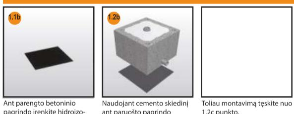
Ant parengto betoninio pagrindo išrenkite hidroizoliaciją (pvz. drėgmeli nelaidžia bitumine juosta) ant kurios vėl uždékite cemento skiedinių.
